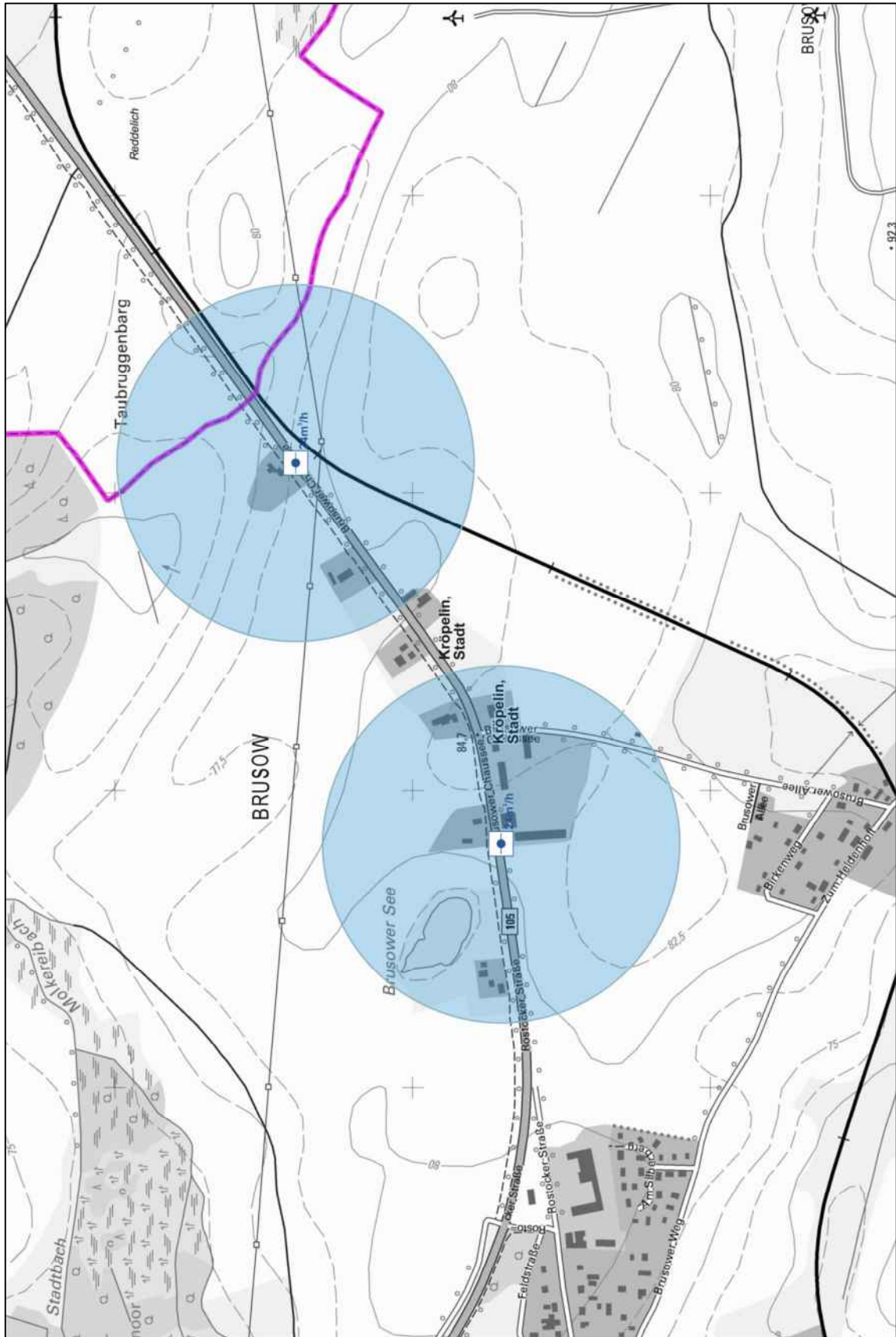
Abbildung 17: Löschwasserversorgung Brusow B 105
